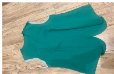
6. Сначала сметываем, а затем стачиваем плечевые (двумя строчками) и боковые швы.
