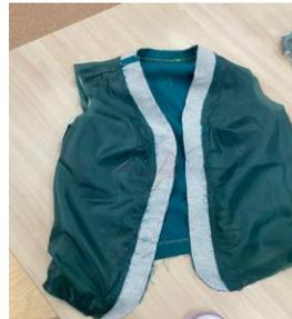
14. Теперь соединяем основное изделие с подкладом. В круговую сначала приметываем, затем притачиваем по подвороту.
